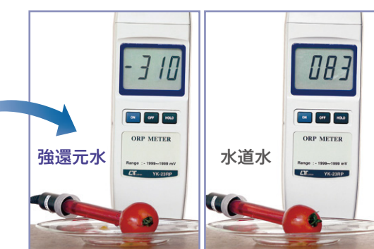
強還元水と水道水に浸したミニトマトの酸化還元電位(ORP)
