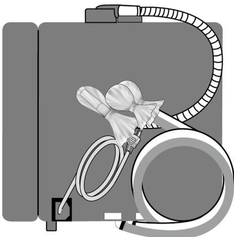
1 フレキシブルパイプを本体背面に沿わせるように曲げる
